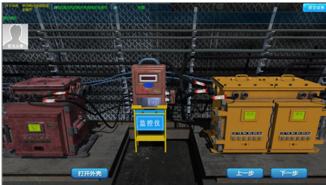
按下通风机实验按钮，馈电柜断电风机停止，点击馈电柜屏幕确认断电，点击下一步
