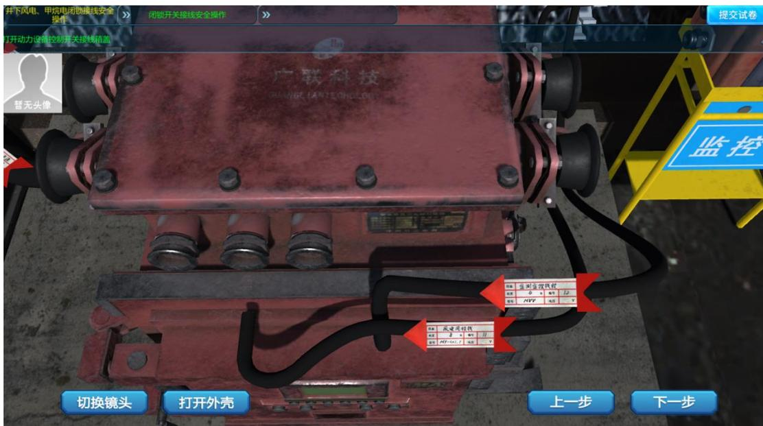
鼠标点击控制电缆，使电缆引入接线箱,操作完成点击【下一步】。
