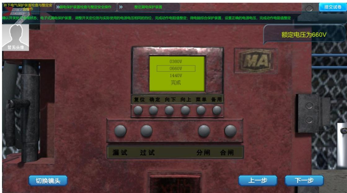
点击检漏继电器，点击连接片调整电压到 660v，点击【确定】，点击【下一步】按钮
