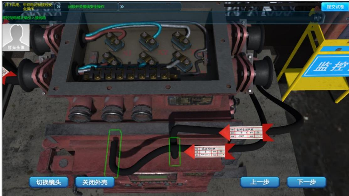
把接线端子插入控制开关闭锁接点,会有下图提示出现,操作完成点击【下一步】。
