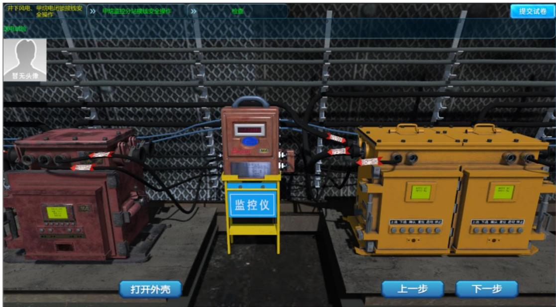
按下甲烷分站实验按钮，点击馈电柜屏幕确认断电，操作完成点击【下一步】按钮，科目二结束
