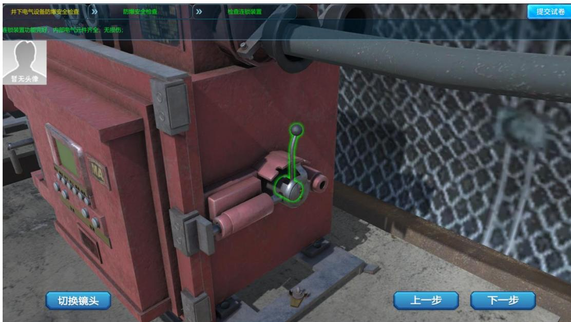
在开盖情况下，闭合隔离开关；在关盖并且闭合隔离开关情况下，开关，操作完成点击【下一步】按钮。
