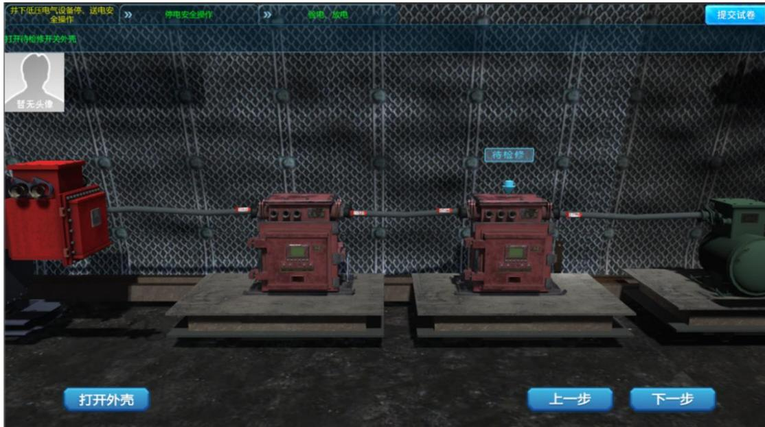
使用单线一头连接【验电笔】，另一端分别连接【X1, X2, X3】，然后使用一通三线，一端连接【接地螺栓】，另外三段连接【X1, X2, X3】，操作完成点击【下一步】按钮。
