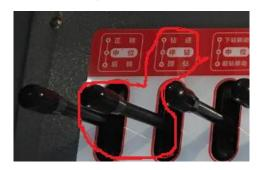
使夹持器和水管往前钻进移动。
