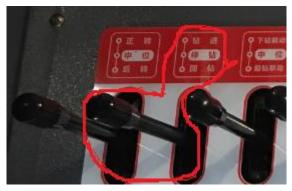
在夹持器移动到最后方后,操作夹持器操作杆到"夹转联动"模式,如下图所示:
