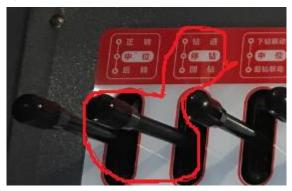
在夹持器移动到最前方后,如有提示"按7加杆",则按操作台上的小键盘数字7键,然后操作夹持器操作杆到"夹持器截止"模式,如下图所示:
