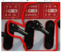
拨到"起钻联动"和"回钻"模式,操作夹持器操作杆到"夹转联动"模式,然后往后拉钻进回钻操作杆,使夹持器和水管往后回钻移动,在夹持器移动到最后方后,操作夹持器操作杆到"夹持器截止"模式,然后往前推"钻进回钻"操作
