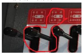
使夹持器和水管往前钻进移动,依次来回这样多次操作,可将钻机钻头送入钻窝或孔底。
