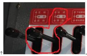
模式, 然后往后拉钻进回钻操作杆
